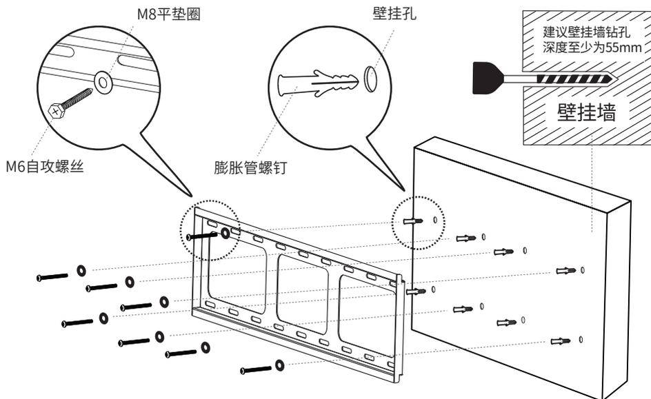
将交互平板垂直水平安装在壁挂支架上，并且确保面板保持在支架的中心。最后，将壁挂竖杆支架上的M5长螺钉拴紧，固定于壁挂架即可完成安装。
